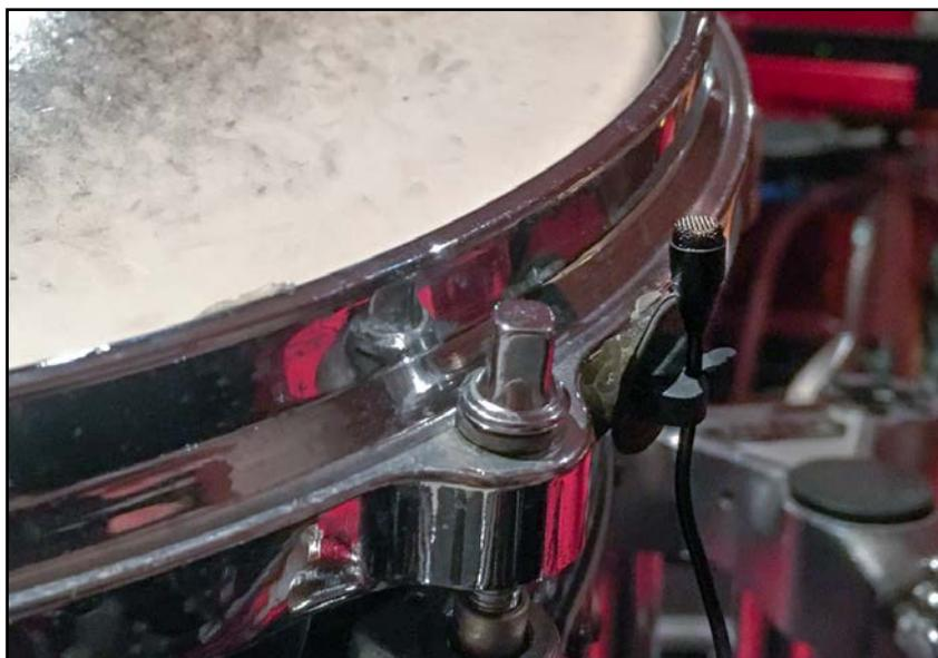
5.a.1 - Placement d'un microphone lavalier (DPA 4061) sur un fût de batterie
