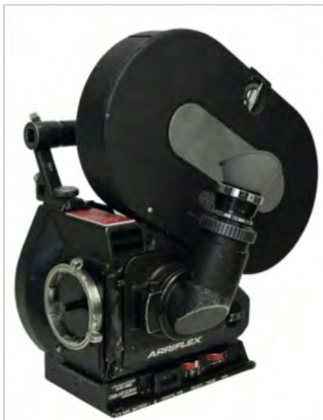
Arriflex : Caméra à obturateur latéral
