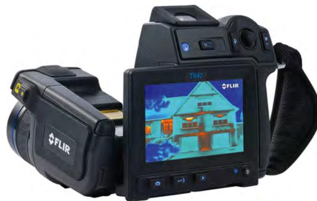
Les caméras FLIR, modèle que j'ai utilisé pour mon film, sont des caméras thermiques équipées de microbolomètres, dont les détecteurs possèdent une faible résolution spatiale, mais une bonne résolution en température.
